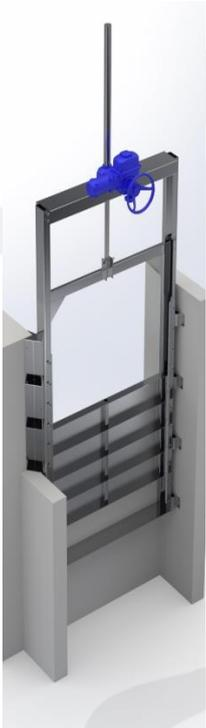
Gargame in acciaio, realizzato in lamiera presso piegata, opportunamente nervato e irrigidito in base alle sollecitazioni previste. I punti di ancoraggio a muro sono idonei al tipo di pressione di lavoro. Struttura monoscocca con guide di scorrimento fino a 1100 mm sopra piano di camminamento.
